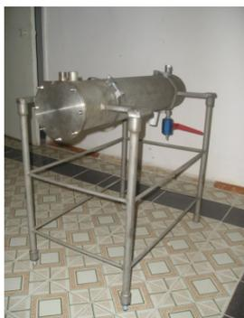
Стенд для калибровки навесного датчика
