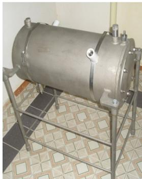
Стенд для калибровки навесного датчика
