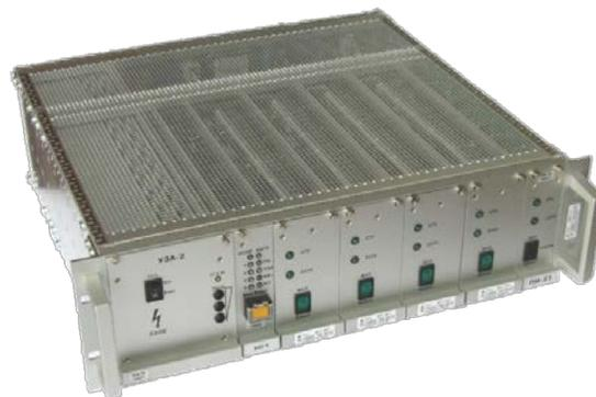
Устройство бесперебойного питания с резервированными блоками питания и аккумуляторными батареями, работающими параллельно по выходу, обладает высокой надежностью и позволяет производить "горячую" замену блоков питания и аккумуляторных батарей без отключения рабочей станции.
